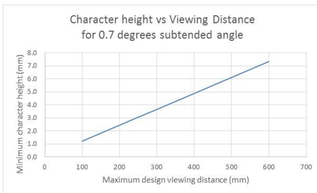
Figure 1 : Relation entre la hauteur minimale des caractères et la distance de vision théorique maximale
